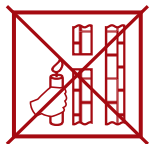
слабая тяга (Не используйте котел!)
